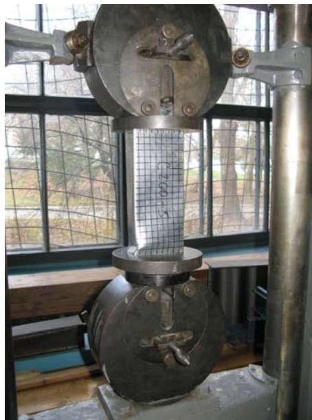
Рис. 2. Випробування на стиск коротких стійок С-подібних профілів
