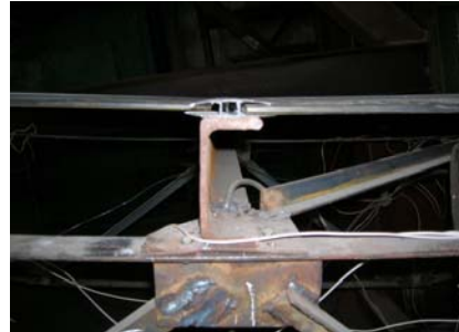
Рис. 12. Узел крепления пластика к несущей конструкции модели
