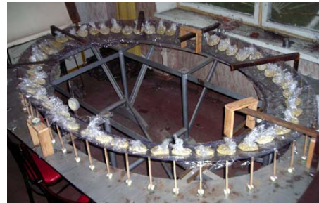
Рис. 7. Общий вид модели мембранного покрытия в процессе испытаний
