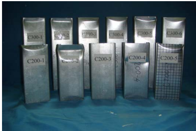
Рис. 4. Характер руйнування дослідних зразків
