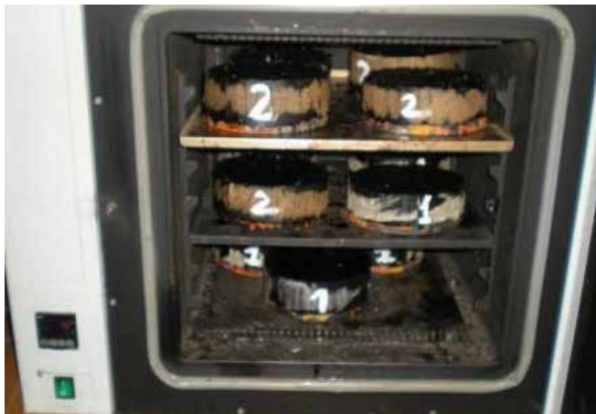
Рис. 7. Зразки-композити термостатуються в сушильний шафі за температури 50°C
