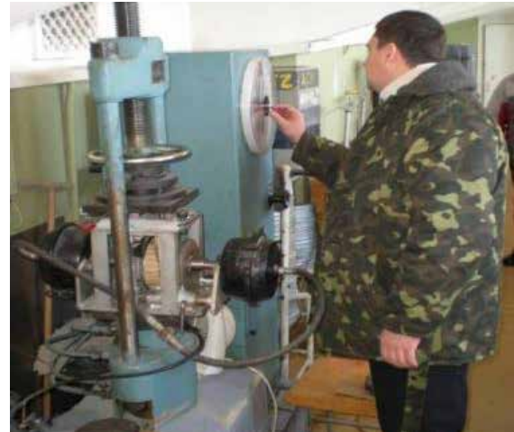
Рис. 8. Перевірка міцності зчеплення між «Гусасфальтом» і гідроізоляцією «Елімінатор», яка знаходиться на металевому диску
