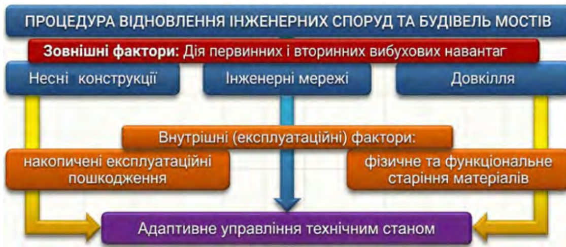
Рис. 8. Використання даних моніторингу для коригування експлуатаційних рішень та оновлення конструкцій
