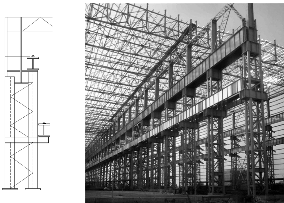
Рис. 2.12. Конструктивна схема колони з двоярусним розташуванням кранів
