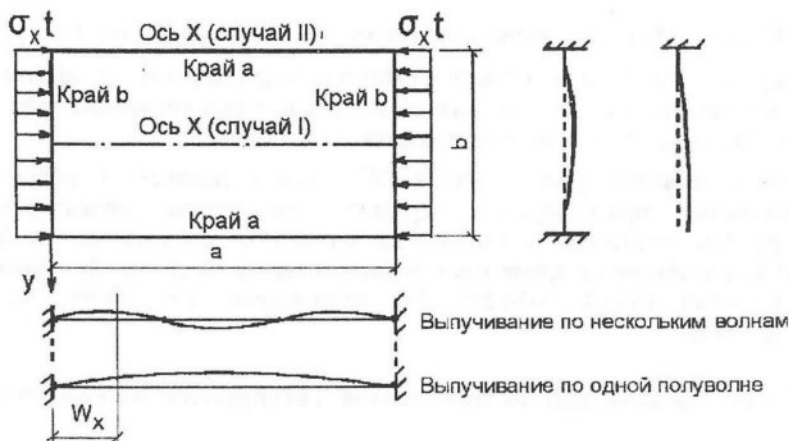
Рис. 3.3. Расчетная схема пластинки
