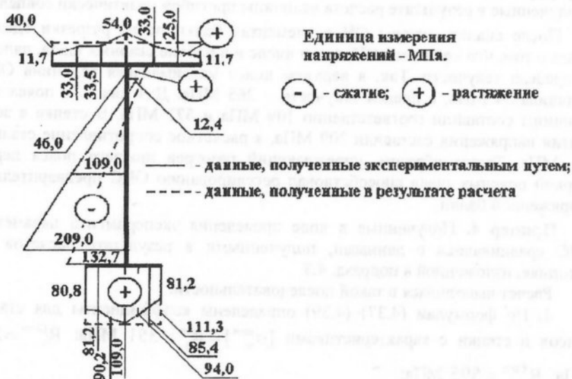
Рис. 4.7. Эпюра ОН в сечении балки после разрезки
