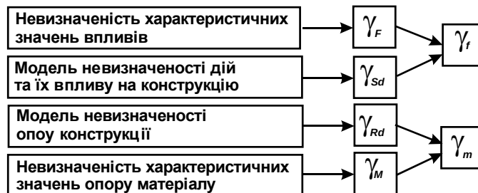
Рис. 2.3. Система часткових коефіцієнтів за EN 1990
