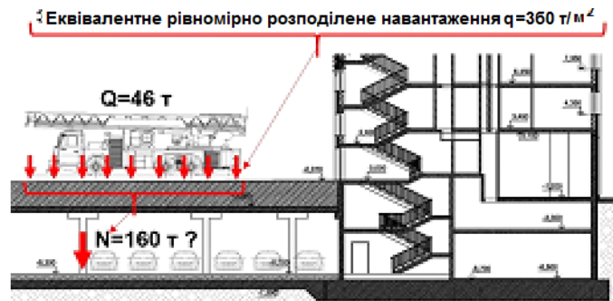
Рис. 4.6. Схема навантажень від протипожежної автотехніки на покриття стилобатної частини житлових комплексів
