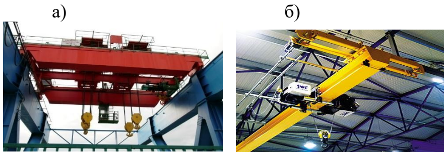
Рис. 4.7. Види виробничих кранів: а – багатоколісний мостовий кран; б - підвісний кран (кран-балка)
