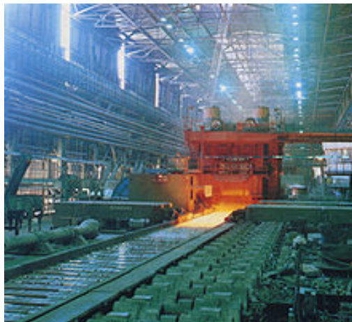
Рис. 1.9. Современный листопрокатный стан
