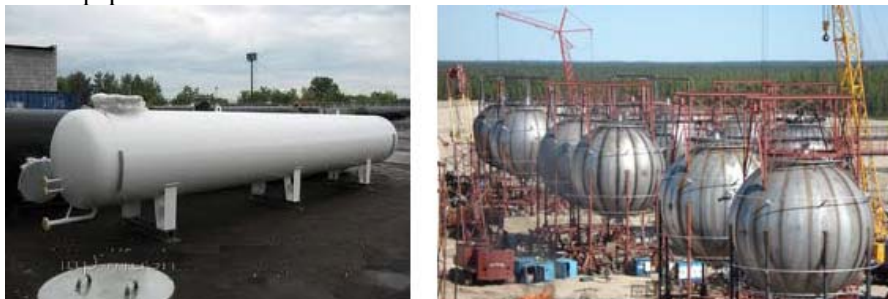
Рис. 8.21. Цилиндрический и сферические газгольдеры высокого давления
