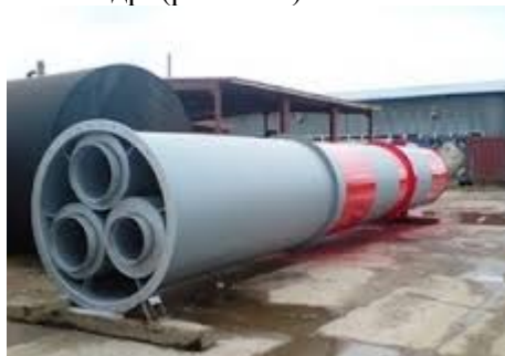
Рис. 6.20. Стальная оболочка с внутренними газоходами
