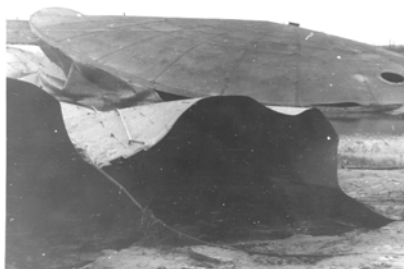
Рис. 8.25. Разрушение резервуара №3: а – отброшены купол и стенка резервуара № 3; б – на старом месте осталось только днище резервуара № 3
