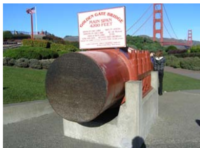
Рис. 9.18. Основной кабель: а — общий вид, б — демонстрационный фрагмент
