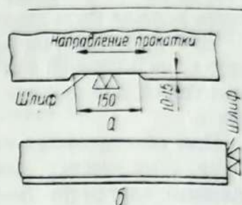
Рис. 53. Расположение шлифов для снятия микроструктуры по способу Баумана:
