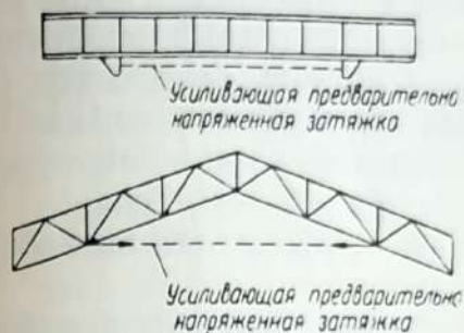
Рис. 66. Усиление балок и ферм дополнительными затяжками.
