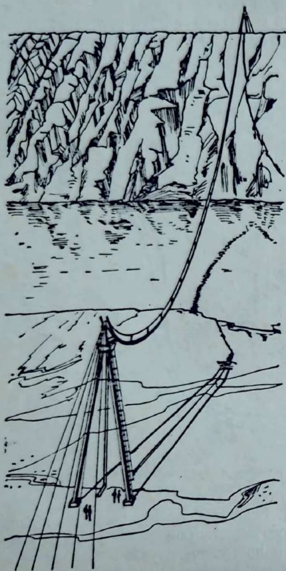
Рис. 18. Переход газопровода через р. Сырдарью.
