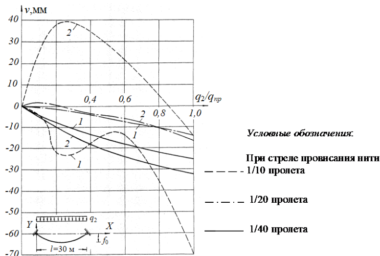
Рис. 10.13. Зависимость перемещений нити конечной жесткости из идеального упруго-пластического материала от интенсивности дополнительной равномерно распределенной нагрузки: 1 – в четверти пролета; 2 – в середине пролета
