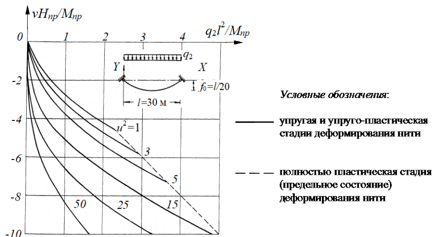
Рис. 10.14. Зависимость перемещений нити конечной жесткости из идеального упруго-пластического материала в середине пролета от интенсивности дополнительной равномерно распределенной нагрузки
