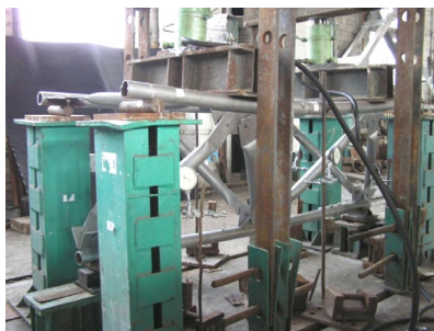
Рис. 5.30. Разрушение пространственно-стрелковой конструкции балки
