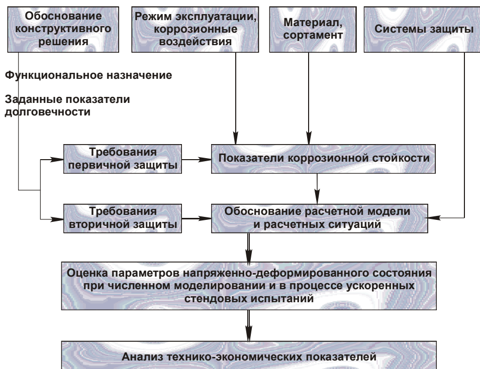
Рис. 3.2. Схема обоснования мероприятий первичной и вторичной защиты стальных конструкций с гарантированными показателями долговечности
