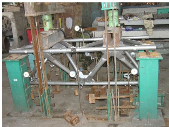
Рис. 5.16. Пространственная ферма-балка перед испытанием
