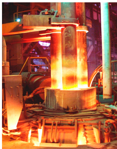
Рис. 6.8. Новые конструктивные и технологические решения агрегата для внепечной обработки стали при реконструкции мартеновского цеха
