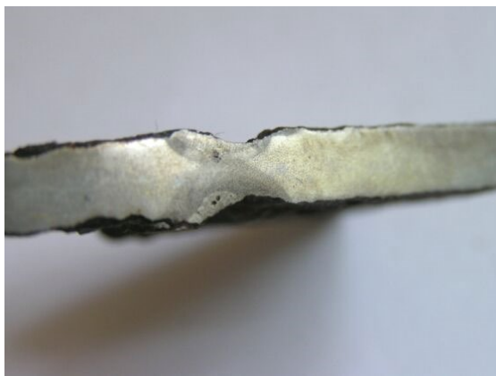
Рис. 3.19. Ослабление сварочного шва внутренними дефектами (шлаковые включения, поры) и коррозионные поражения
