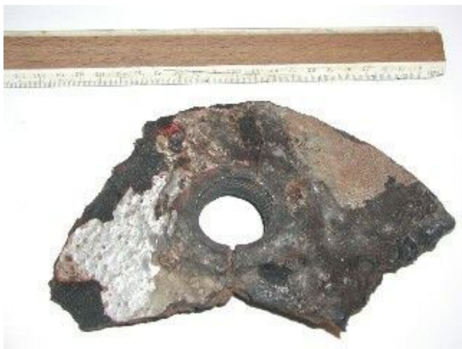
Рис. 1.18. Общий вид коррозионно-механического разрушения фрагмента корпуса заслонки
