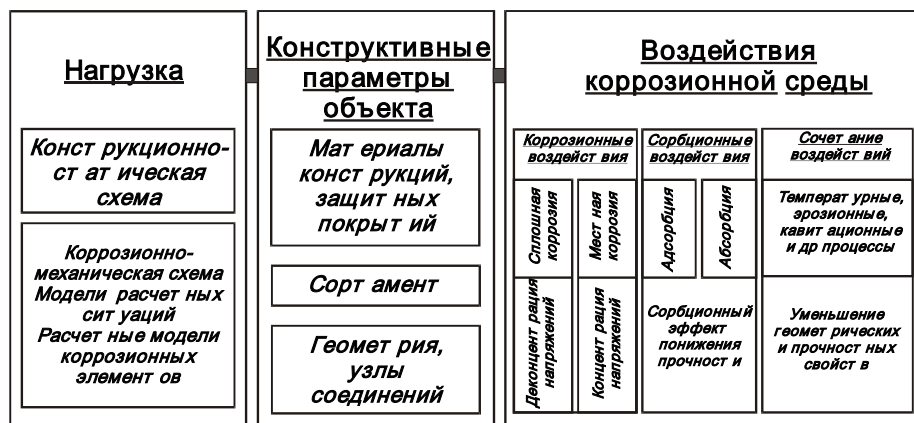
Рис. 5.2. Факторы, влияющие на коррозионное разрушение под напряжением
