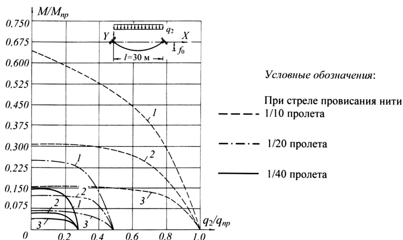
Рис. 8.16. Зависимость изгибающего момента в нити конечной жесткости из идеального упруго-пластического материала в середине пролета от интенсивности дополнительной равномерно распределенной нагрузки: 1 – u^2 = 5 ; 2 – u^2 = 15 ; 3 – u^2 = 25
