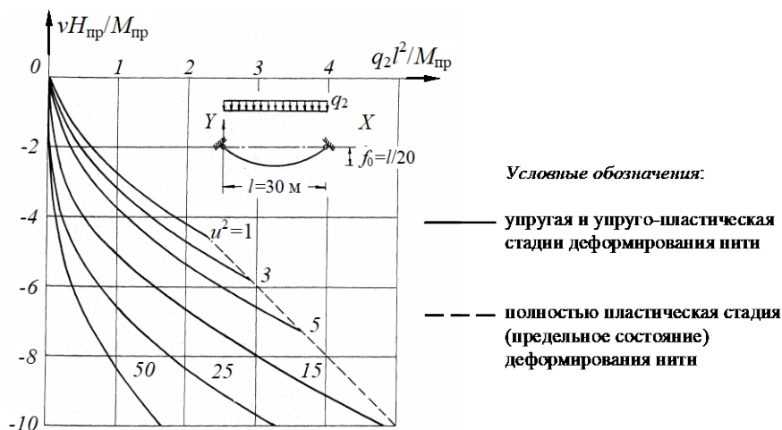
Рис. 8.14. Зависимость перемещений нити конечной жесткости из идеального упруго-пластического материала в середине пролета от интенсивности дополнительной равномерно распределенной нагрузки
