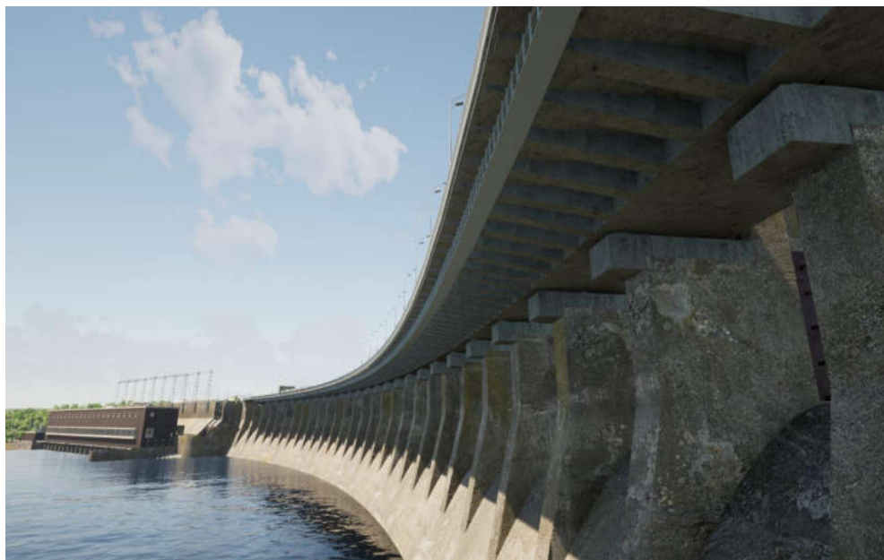
Рис. 2.23. Загальний вигляд нового чотирисмугового автодорожнього проїзду за першим концептуальним варіантом реконструкції з застосуванням монолітних залізобетонних конструкцій (вид з нижнього б'єфу з боку лівого берега р. Дніпро)
