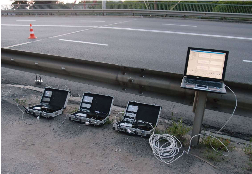
Рис. 1.58. Загальний вигляд автономної багатоканальної вібровимірювальної апаратури під час проведення динамічного обстеження конструкцій земляної вставки
