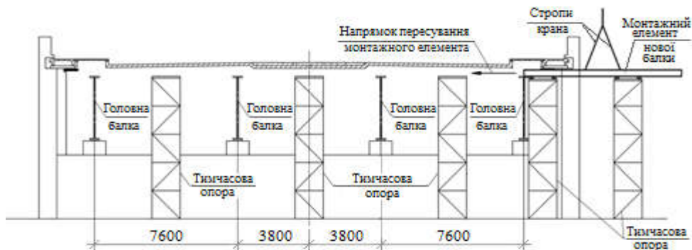
Рис. 3.7. Схема монтажу нової поперечної балки
