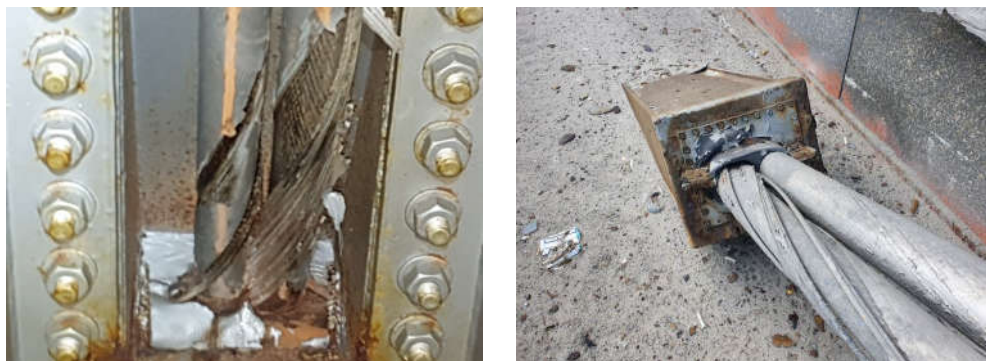
Рис. 3.3. Обриви дротин зовнішнього шару канатів вант Південного моста
