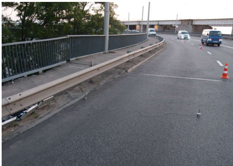
Рис. 1.59. Розміщення датчиків вібрації відповідно до схеми 2 у 2,5 м від деформаційного шва ДШ-3 на Опорі № 0
