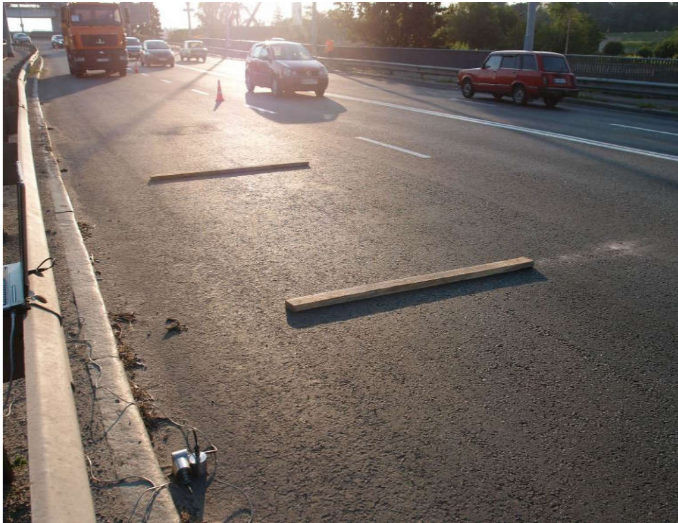
Рис. 1.60. Розміщення датчиків вібрації відповідно до схеми 5 у процесі проведення досліджень при переїзді вантажівки через штучно влаштовані перешкоди
