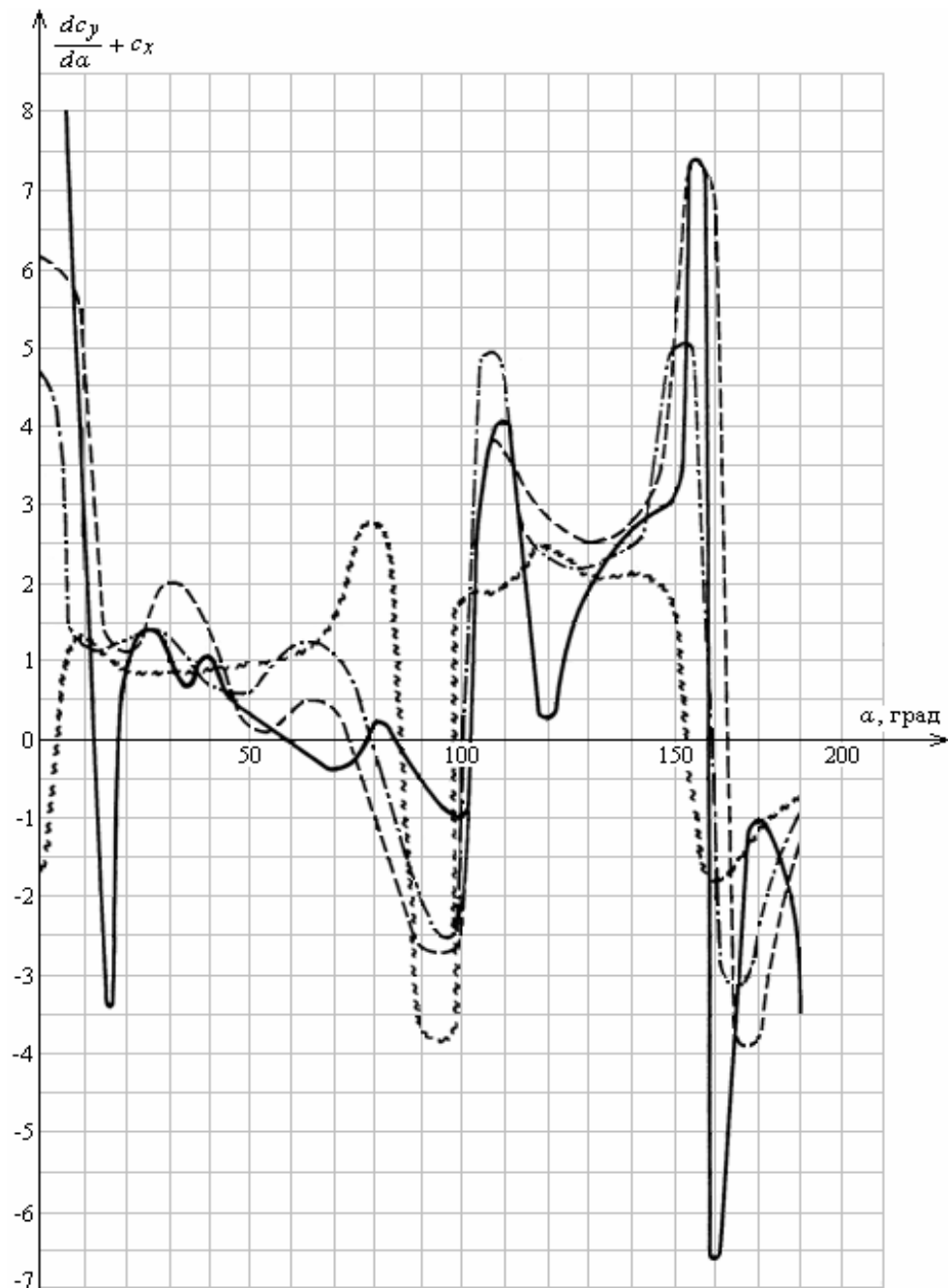
Рис. 6.16. Графики зависимости обобщенного критерия Глауэрта – Ден-Гартога от угла атаки (dc_y/d\alpha + c_x) = f(\alpha) для некоторых поперечных сечений профилей в виде: - - - - - трапеции с d/b = 1,64 ; - · - · - трапеции с d/b = 1,09 ; ~ ~ ~ ~ - трапеции с d/b = 0,62 ; ———— - клина с углом раствора 30^\circ
