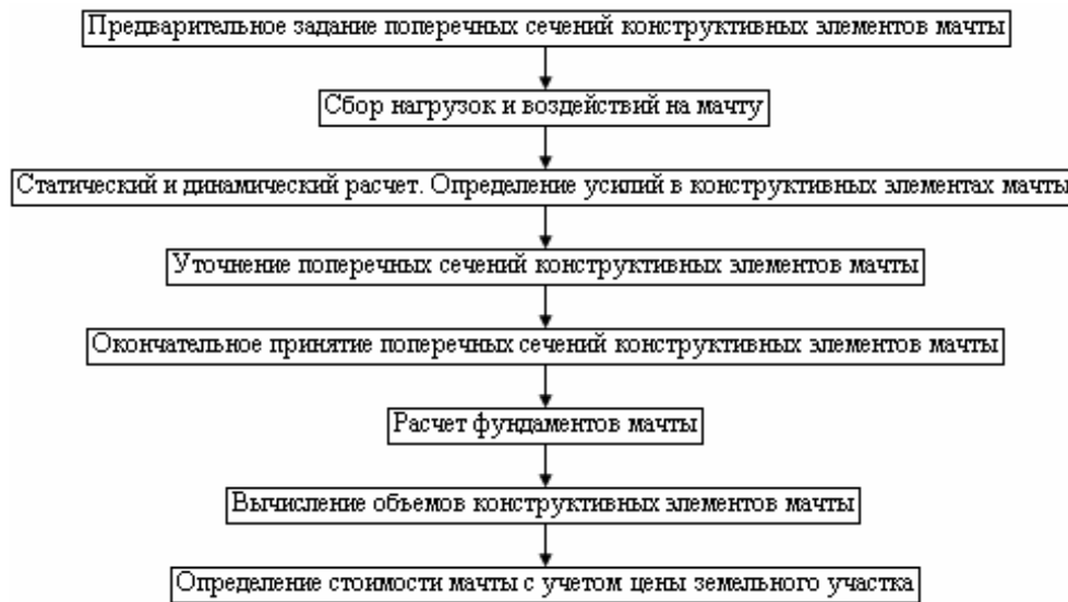
Рис. 8.14. Укрупненная блок-структура алгоритма определения оптимальной стоимости мачты с учетом цены земельного участка
