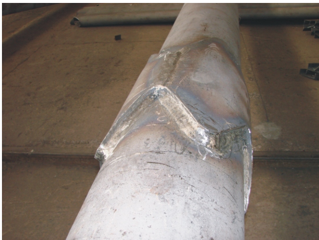
Рис. 5. Стик трубчастих елементів із накладками у вигляді фігурних муфт: а – загальний вигляд; б – принципова схема
