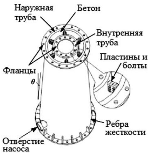
Рис. 3. Ствол трубобетонной опоры с двойной оболочкой (CFDST)
