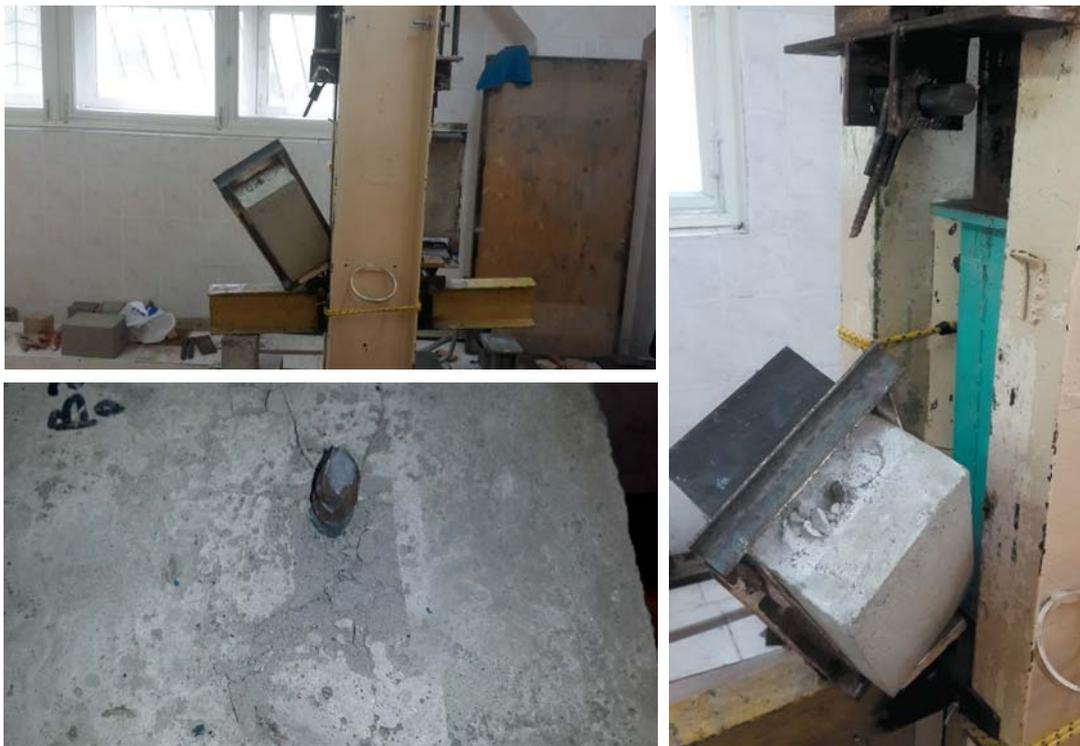
Рис. 2. Разрушение вследствие разрыва арматуры при выдергивании в образце AN-V-300-13
